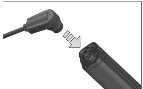
Abb. 4: Service Dongle mit Batterie verbinden
